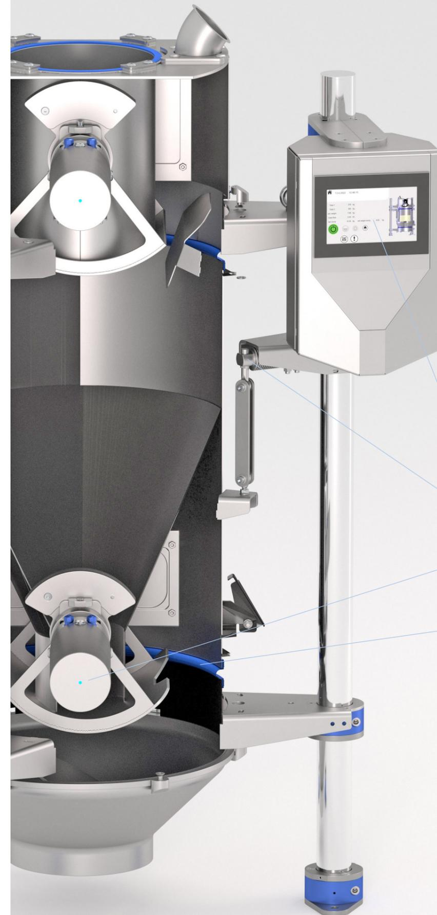
IoT kompatible Steuerung mit intuitiver Touch-Screen Bedienung
