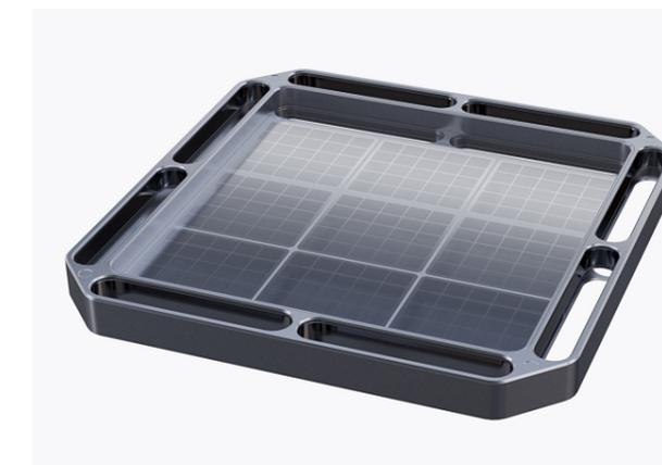
Die Siebe liegen tief im Rahmen und bieten so viel Produktraum. Diese Konstruktion ist nicht nur für die Maximierung der Kapazität von Vorteil, sondern auch für die Abdichtung nach aussen, ohne dass Filz oder andere Dichtungsmaterialien erforderlich sind. Ein grosser Querschnitt für das Durchfallprodukt unterstützt den Produktfluss, und die vollständige Edelstahlkonstruktion minimiert den Abrieb.
