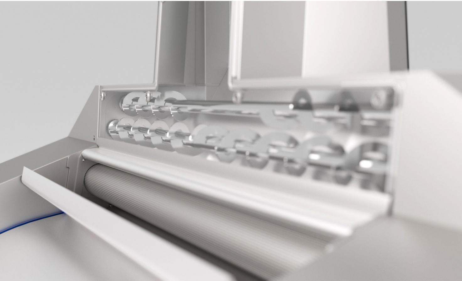
Die Speisung besteht aus zwei Verteilschnecken, einer Speisewalze und der Speisespaltverstellung. Jedes Element lässt sich individuell einstellen, um einen gleichmässigen Massenfluss und eine gleichmässige Granulation zu gewährleisten.
